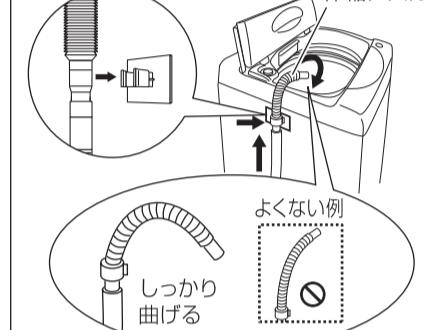
**お願い** 給水時に水の重みで伸縮ノズル先端の向きが変わることがあります。テスト運転を行い、洗濯機内に水が入ることを確認してください。
