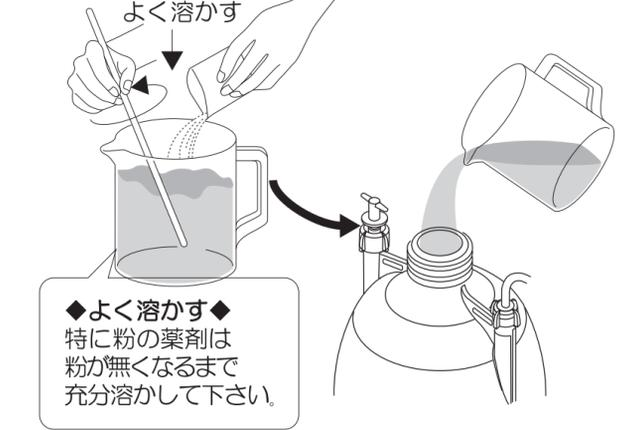
**注意** 前回使用した薬剤が残っていないか確認して下さい。化学反応を起こし、有毒ガスが発生する危険があります。
