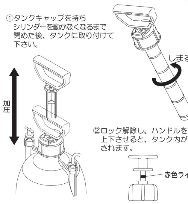
③噴霧適正圧力になり安全弁から「シュー」という音が聞こえたら加圧をやめて下さい。(この時、安全弁の赤色ラインが見えることにより確認できます。)
