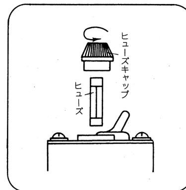
ヒューズは指定容量以上の電流が流れると自動的に切れます。その場合は、ヒューズキャップを矢印の方向に廻して取り外し、中からヒューズを取り出して、新しいヒューズと取替えて下さい。
