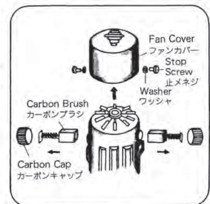
1. ファンカバーの3ヵ所の止めネジをドライバーにて取り外し、ファンカバーをモートルから外して下さい。
