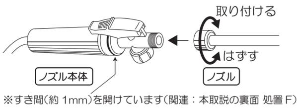
**注意** 接続部にはパッキンが付いています。必ずパッキンがあることを確認して下さい。また、液漏れがないようしっかりと締め付けて下さい。
