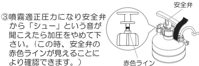
**安全弁** 加圧しすぎによる噴霧器の故障を防止するため安全弁が付いており、適正圧になると自動的に圧力が逃げます。
