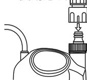
①ホース側継手を取り付けるときは、ポンプ側継手に差し込みます。
