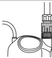
②ホース側継手を取り外すときは、リング部を持ち上げながら抜きます。
