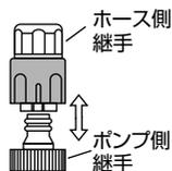
②ポンプ側継手とホース側継手を分離します。
