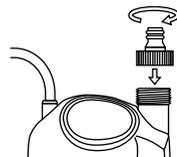
③ポンプ側継手をポンプの吐出口に取り付けます。
