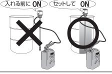
Bトラム缶内の 液体よりも低い位置に ノズルがあると 「サイフォンの原理」 により中の液体が 漏れることが あります。 ポンプをドラム缶 から外して保管して ください。
