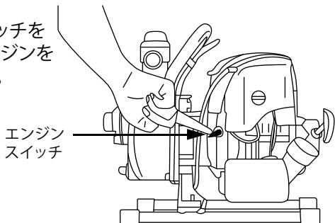
・引き続きあとの作業がない場合は、燃料タンクの燃料を抜き取り、再始動してキャブレター内の燃料を使い切ってください。
