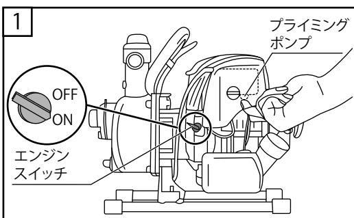
エンジンスイッチをONにします。プライミングポンプを指で押します。(10回以上) プライミングポンプを押すのは燃料をキャブレターに汲み上げるためです。
