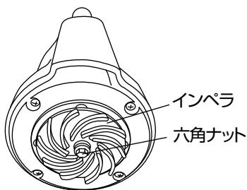
③インペラを手で持ってシャフトに付いている六角ナット(M6)を外します。(ナットを外すと、歯付き座金と平座金が外れます。)
