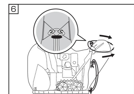
同様に操作部側のヒモを固定し、余ったヒモを操作部に回して結ぶ。
