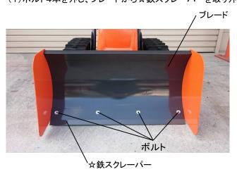
(3)ブレードに①ゴムスクレーパーを取り付けします。 このとき、☆鉄スクレーパーを押さえとして使用します。
