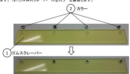
(4)☆鉄スクレーパーを長穴いっぱいに下げた位置で ③フランジボルト4本をしっかり締めます。
