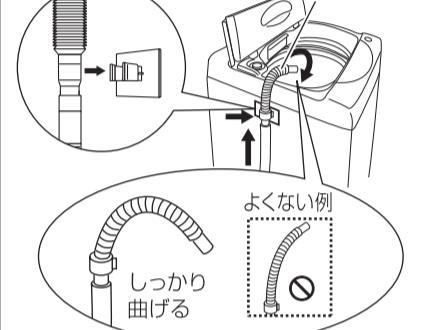
**お願い** 給水時に水の重みで伸縮ノズル先端の向きが変わることがあります。テスト運転を行い、洗濯機内に水が入ることを確認してください。
