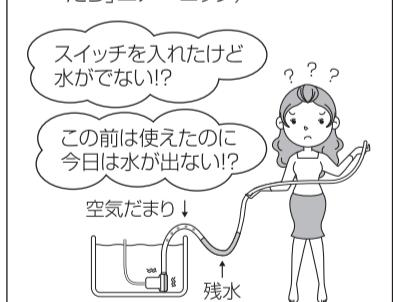
ホース内の水を抜かないとい、次回使用時にホース内に残った水が空気だまりを作り水の流れを止め、吸い上げできなくなります。
