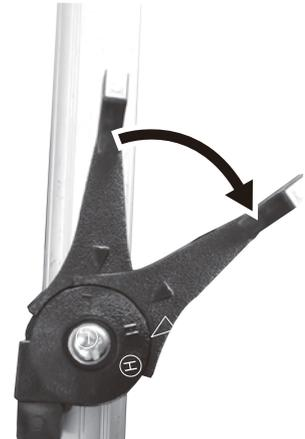
3. 機械の異常の有無を確認のうえ、調圧ハンドルを回して、「除草」「噴霧」「高圧」と作業条件にあった圧力の設定をします。
