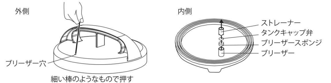
**警告** ブリーザー穴が詰まると散布時にタンクが“へこみ”破損する恐れがあります。
