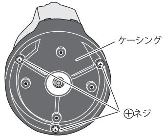
②ケーシング下部の $+$ ネジ3本を外し、ケーシングを外します。
