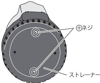
①ストレーナー底面の $+$ ネジ2本を外し、ストレーナーを外します。
