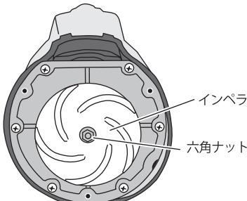
③インペラを手で持つてシャフトに付いている六角ナット(M6)を外します。(ナットを外すと、歯付き座金と平座金が外れます。)
