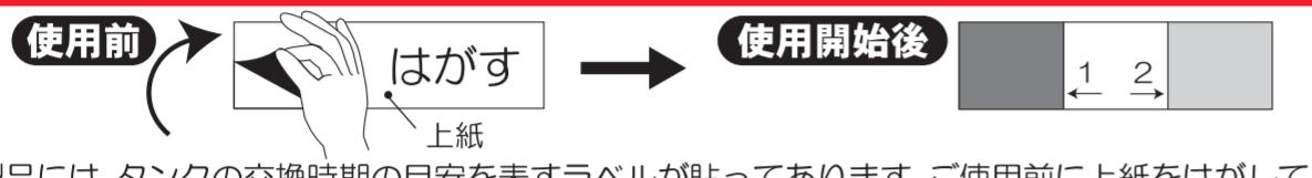
製品には、タンクの交換時期の目安を表すラベルが貼ってあります。ご使用前に上紙をはがして下さい。1の色が2の青色になったらすぐに使用を中止しタンクを交換して下さい。タンクは紫外線が多く当たると劣化し、破裂する恐れがあります。このラベルは紫外線で色が変化し、タンクの交換時期をお知らせするものです。ラベルをはがさないよう注意して下さい。
