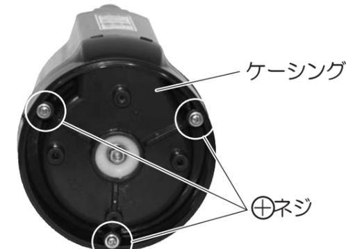
②ケーシング下部の⊕ネジ3本を外し、ケーシングを外します。
