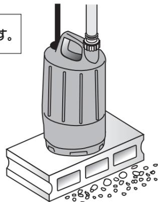
8. 発電機を使用する時は、ポンプの消費電力の3~5倍の容量をもった発電機を使用して下さい。起動時に定格の3倍程度の電流が流れるので、正常に作動しない場合がある為です。
