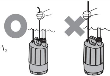
2. 水が一番溜まりやすく安定した場所へ垂直に設置して下さい。泥土や砂地の場所でのご使用は、ポンプ下にブロックや木片を置き水底から離して下さい。
