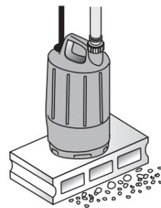
**注意** 吐出ホースの先端が水面よりも低い場所にある場合、ポンプ停止時にサイフォン現象により水が流出します。ポンプ停止時にはホースを水面より高い位置に置いて下さい。
