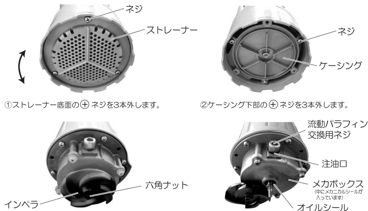
①ストレーナー底面の⊕ネジを3本外します。
