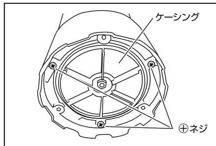
②ケーシング下部の⊕ネジ3本を外し、ケーシングを外します。
