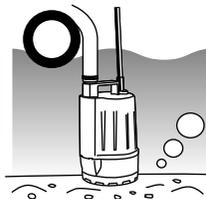
8. ホースを接続する時は、製品付属のカップリングやホースバンドをご使用の上、確実に取付けてください。(ホースの取付方法参照 P.10)
