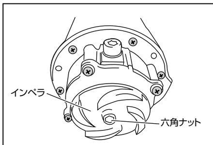
③インペラを手で持ってシャフトに付いている六角ナット(M6)を外します。(ナットを外すと、スプリングワッシャーと平ワッシャーが外れます。)
