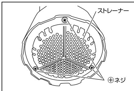
①ストレーナー底面の⊕ネジ3本を外し、ストレーナーを外します。
