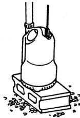
土砂等が混入した水を使用されますと故障の原因になります。
