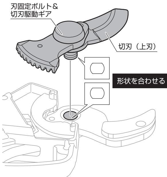
4) 本体を裏返し、刃固定ナットと緩み止めボルトを取り付ける。
