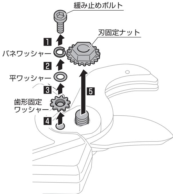
3) 本体を裏返し、刃固定ボルト&切刃駆動ギアと切刃（上刃）を取り外す。
