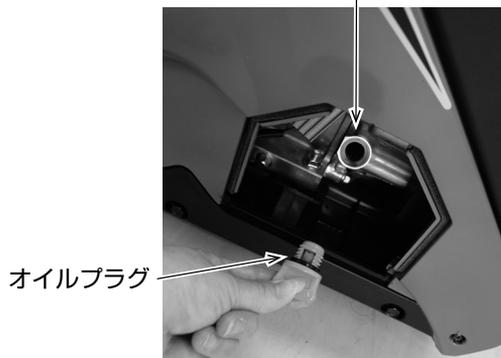
**3** 給油したらオイルプラグを取り付け、確実に締め付ける
