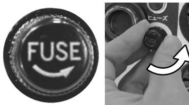
交換後、カバーを時計回りに回ししめます。
