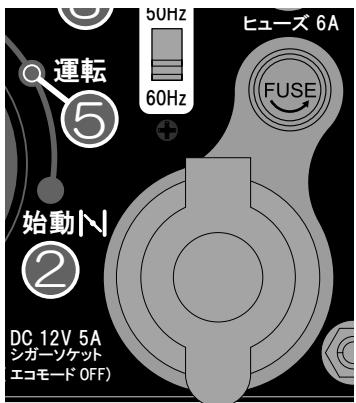
ヒューズ交換方法：エンジンスイッチをOFFにし、エンジンを停止します。カバーを反時計回りに回しあげます。
