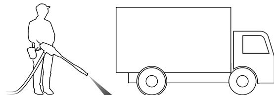
噴射直後はホースの中に空気がたまっているため、水は徐々に出てきます。トリガーをにぎって30秒ぐらいで水が安定して噴射します。
