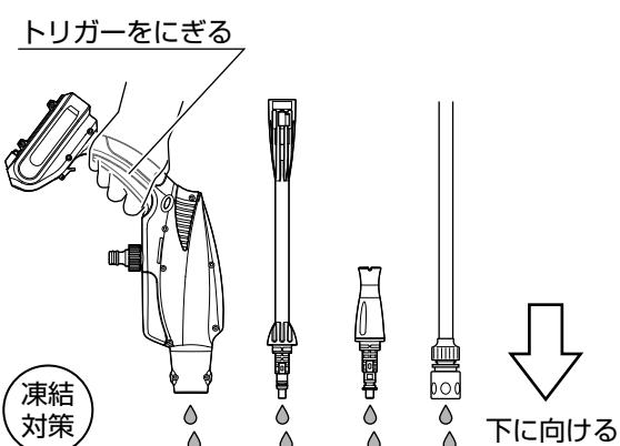
4) カップリング（本体側）を外し、本体を傾け、内部の水を出す。
