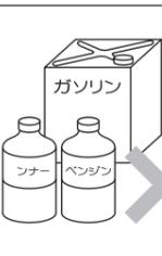
薬剤を使用する時は本機の取扱説明書に記載されている主要薬剤適合一覧表を確認の上、使用してください。強酸性・強アルカリ性の液体、ベンジン・ガソリン等の可燃性の液体、溶剤等は絶対に使用しないでください。爆発する恐れがあります。ゴキブリ・ハエ・蚊等に用いる殺虫剤・防疫用薬品、下水・便所等に用いる消毒剤、畜産用薬品は絶対に使用しないでください。故障の原因となります。
