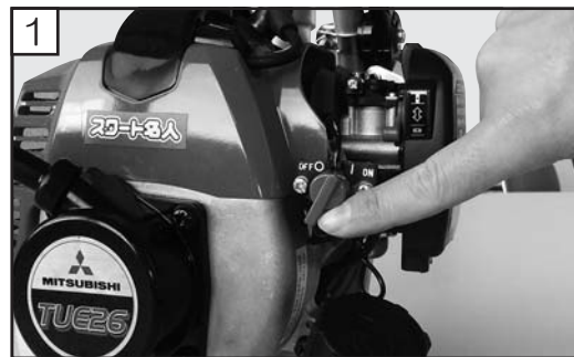
1 エンジンスイッチをON側にします。
