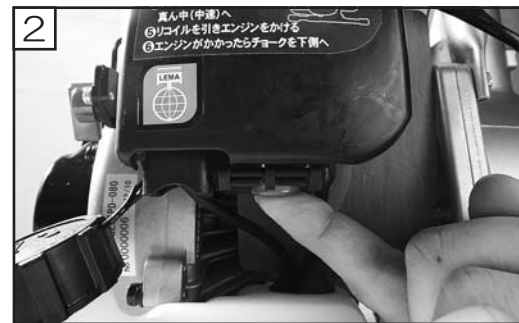
2 プライミングポンプを指で押します。(10回以上) プライミングポンプを押すのは燃料をキャブレターに汲み上げるためです。
