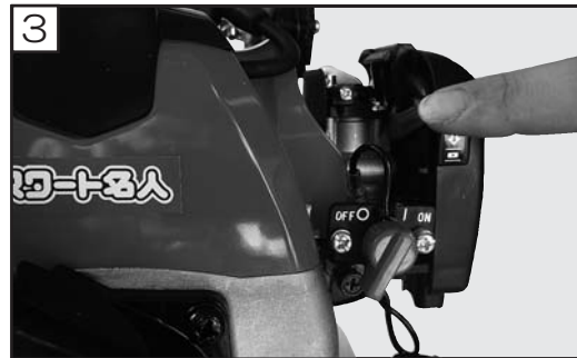
3 チョークレバーを全閉位置(上側)にしてください。燃料が残っていて、且つエンジンが暖まっている場合や夏期は、チョークレバーは全開位置(下側)にしてください。
