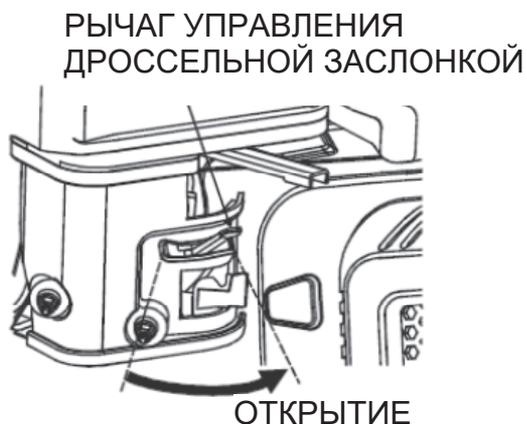
2. Перевести рычаг-регулятор оборотов в соответствующее положение для работы бензинового двигателя на требуемой частоте вращения.
