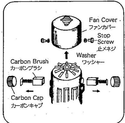
1. 電源との接続がはずれている事を確認して下さい。
