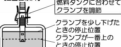
注 停止時に、ホース内の灯油も燃料タンクへ入りますので、その量も見込んで停止位置をクランプレバーで調整してください。(停止線は目安です。通常停止線より下で止まります)
