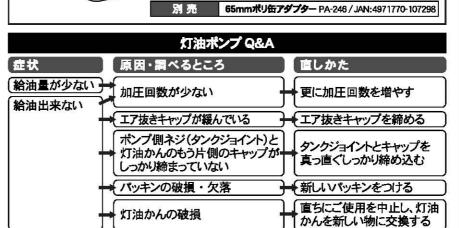
機 種 名 PK-21 合油能力 6L/分(灯油)\* **正** 使用温度範囲 | 約 −5℃~+45℃ 主 材 料 [本体・ノズル]ポリエチレン・ポリアセタール 「木ース】ポリエチレン T油かん口外径50mm対応(JISマーク/推奨・認定マーク付灯油かん専用)
