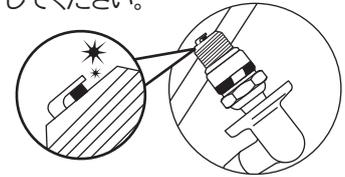
・点火プラグの清掃や、すき間調節をしてもエンジンがかからない場合は、新しいプラグに交換して下さい。
