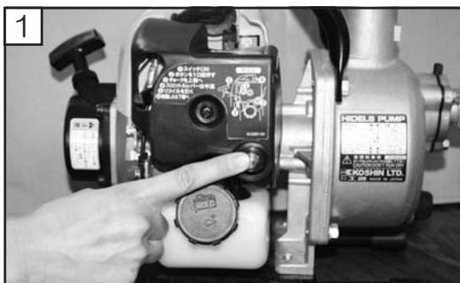
1 プライミングボタンを指で押します。(10回以上)プライミングボタンを押すのは燃料をキャブレターに汲み上げるためです。
