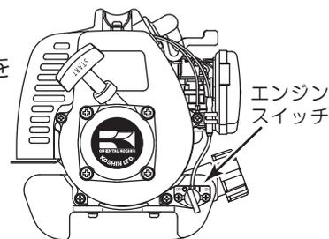
・引き続きあとの作業がない場合は、燃料タンクの燃料を抜き取り、再始動して気化器内の燃料を使い切ってください。
