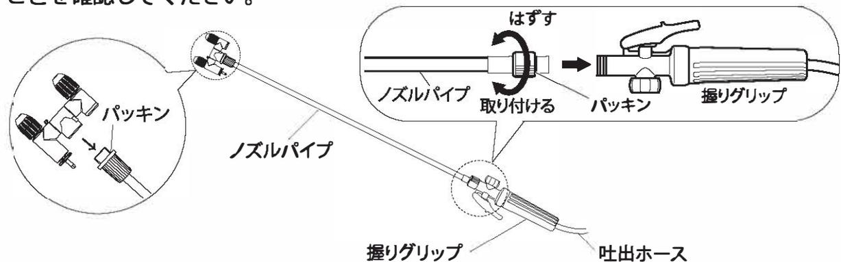
2. ノズルパイプの先端に下記の噴口から必要なものを選んで取付けます。
