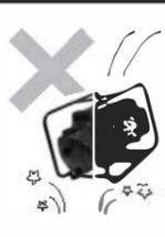
このポンプは樹脂でできていますので、叩いたり落としたり等の衝撃を与えないでください。また、吸入口、吐出口、プラグは締めすぎないでください。特に鋼管を直接ねじ込む場合は十分に注意してください。破損する恐れがあります。
