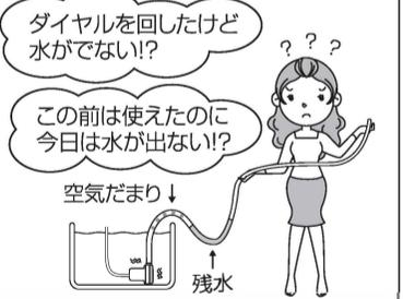
ホース内の水を抜かないと、次回使用時にホース内に残った水が空気だまりを作り水の流れを止め、吸い上げできなくなります。
