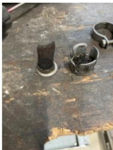
④取り外した部品の網目部分をブラシなどでサツサツと掃うように溜まった煤を清掃してください。
