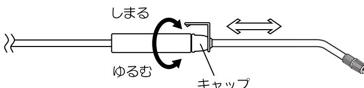
**△ 注意** 接続部にはパッキンが付いています。必ずパッキンがあることを確認して下さい。また液漏れがないようしっかりと締め付けて下さい。
