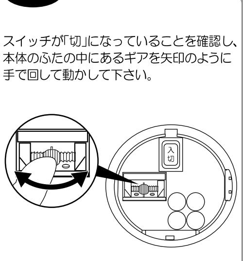
スイッチが「切」になっていることを確認し、本体のふたの中にあるギアを矢印のように手で回して動かして下さい。
