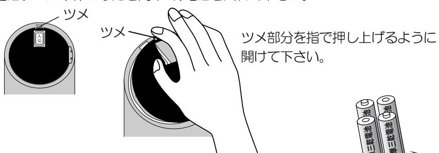
**△ 注意** 乾電池の $\oplus$ (プラス)、 $\ominus$ (マイナス)は、正しく入れて下さい。次のような乾電池の組合せでの使用はしないで下さい。
