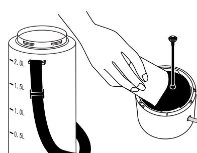
3. きれいな水をタンクに入れて約1分間噴霧し、ポンプ・ノズル内に残っている薬液も洗い流して下さい。
